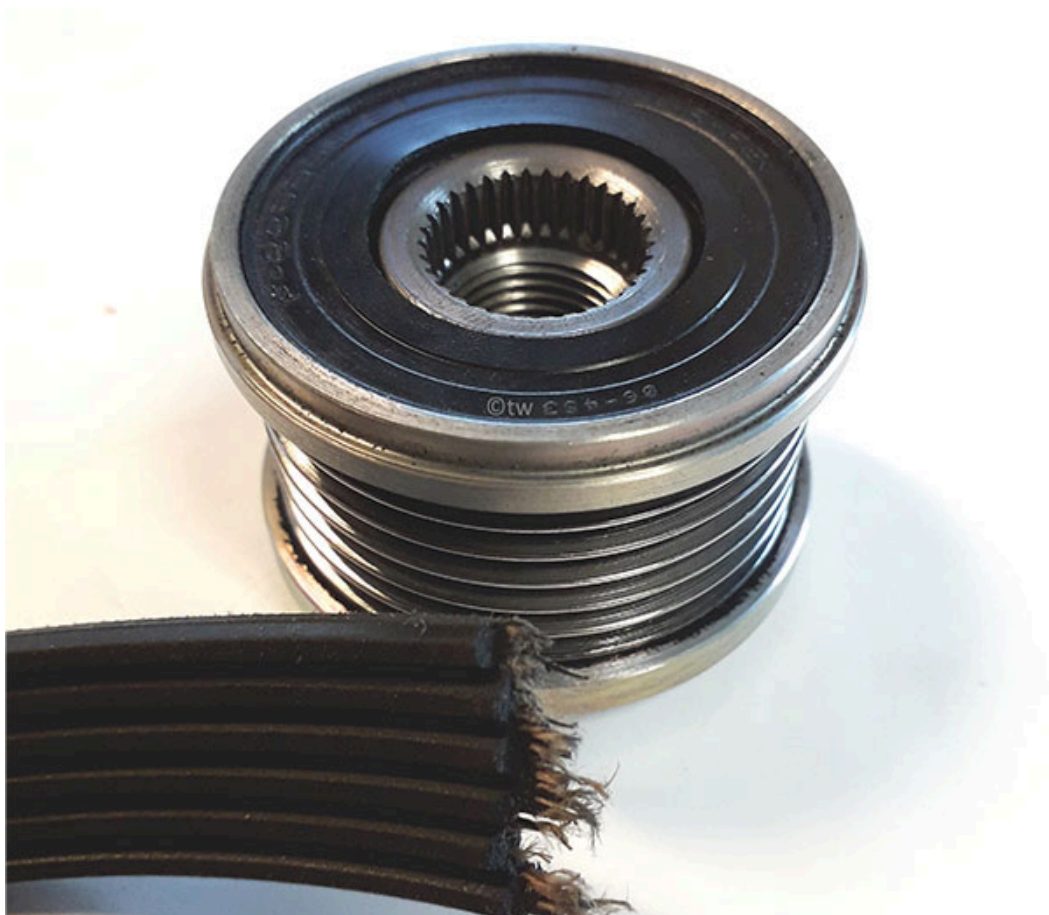
Puleggia a ruota libera difettosa con cinghia poly-V rotta
