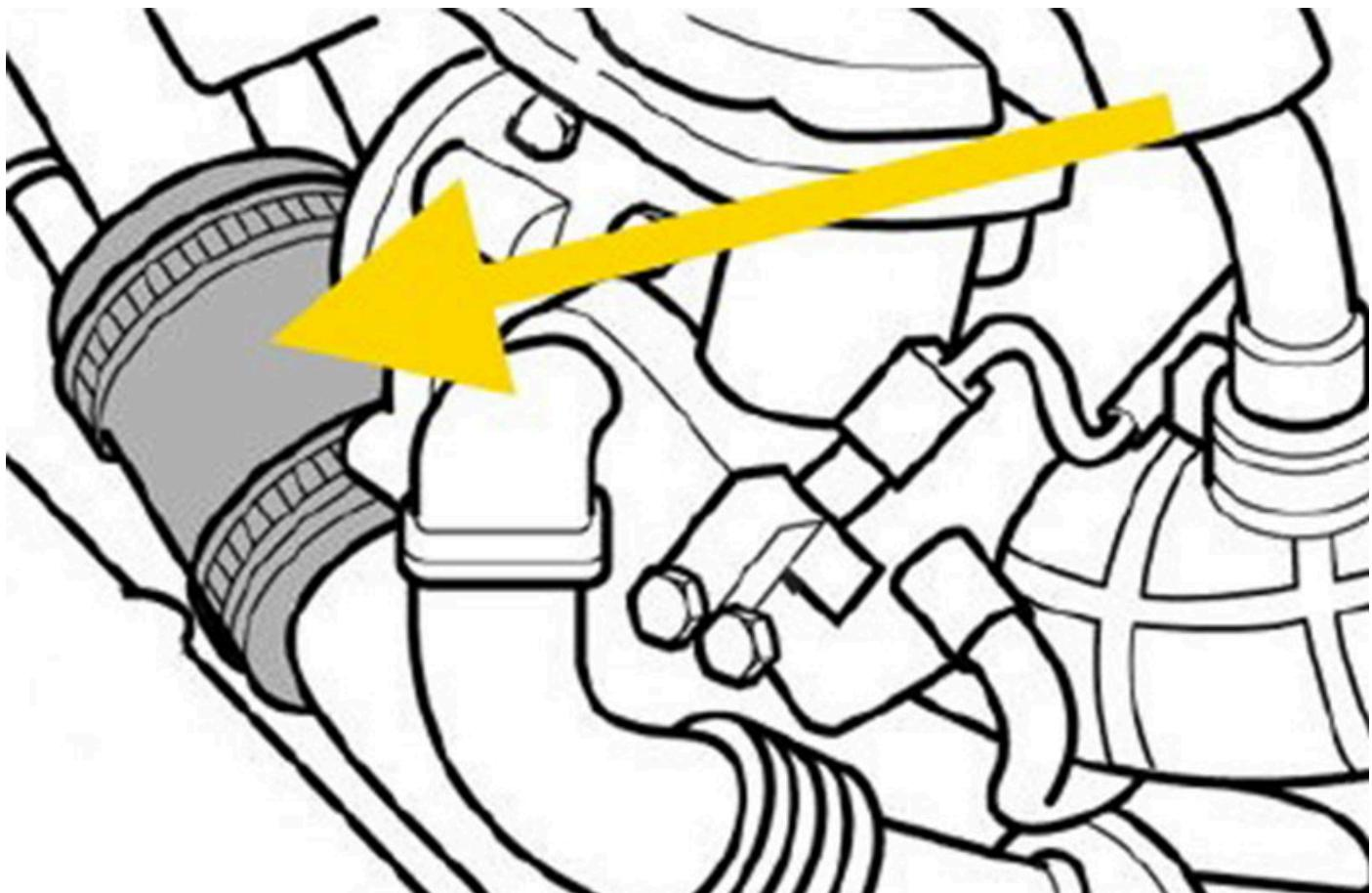
Rimuovere il tubo flessibile (vedi marcatura) tra il turbocompressore e l'attuatore della valvola dell'aria di aspirazione.
