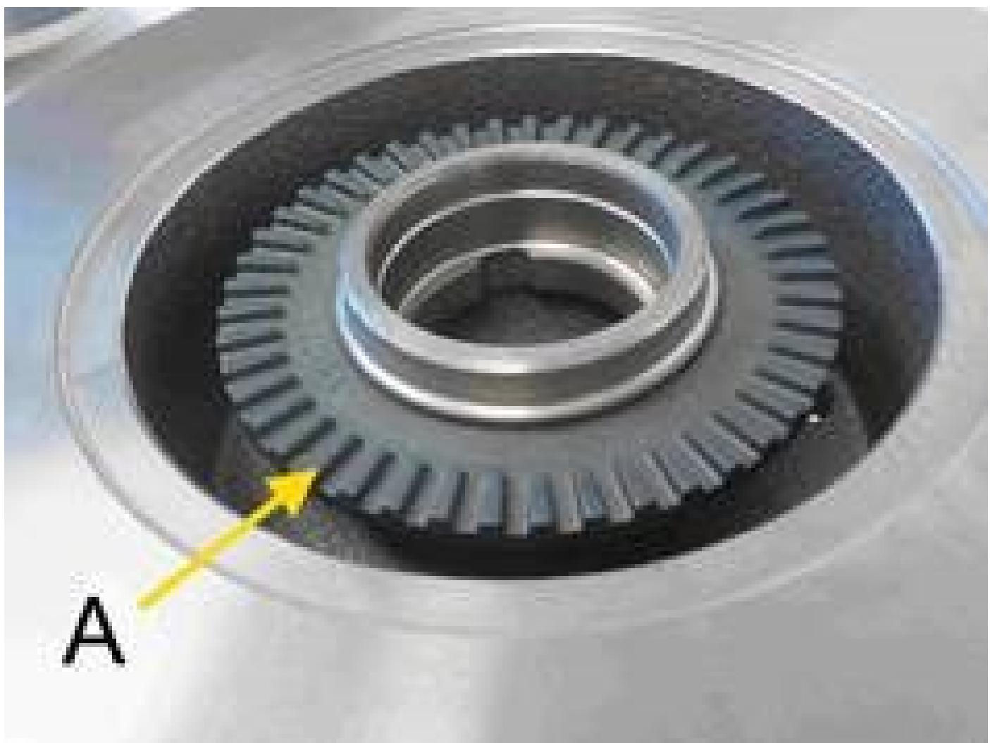
Disque de frein sans roulement de roue, mais avec une bague d'impulsion fixée en permanence et des segments dentés agencés verticalement (A).
