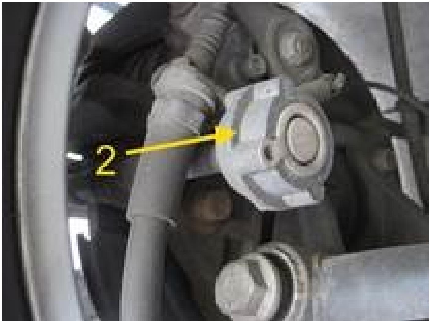
**Les amortisseurs de vibration montés en usine par le constructeur automobile doivent, dans le cas du remplacement de l'étrier de frein, être réinstallés sur le nouveau composant.**
