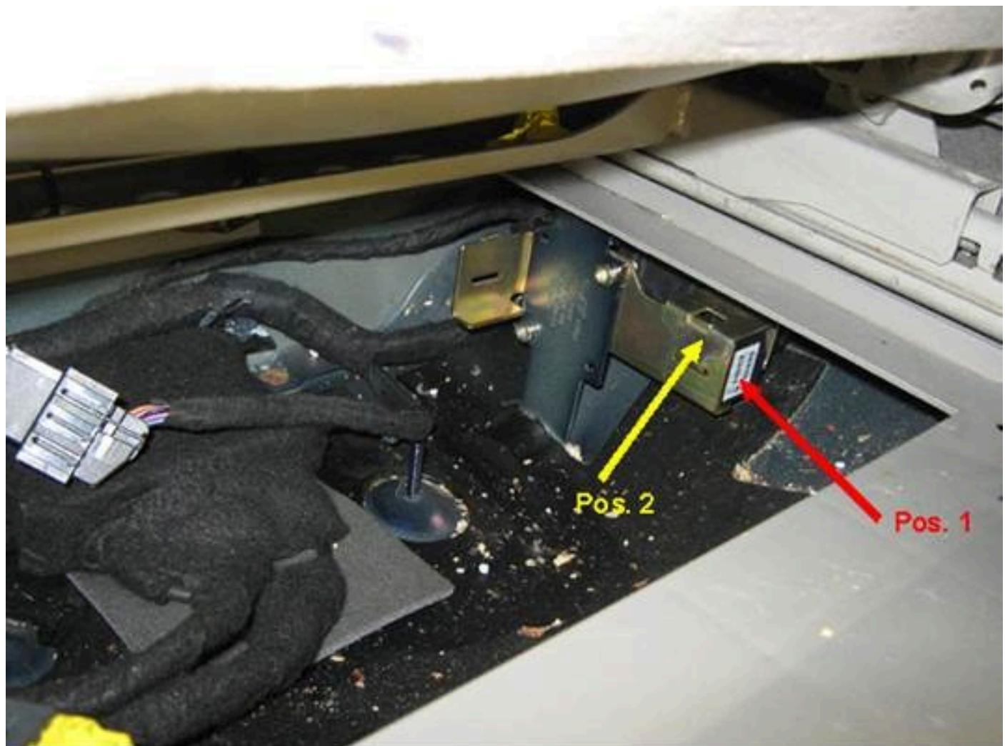
Pour être sûr que la cause du défaut est dans le capteur, lire d'abord la mémoire des défauts et contrôler le câblage du capteur.
