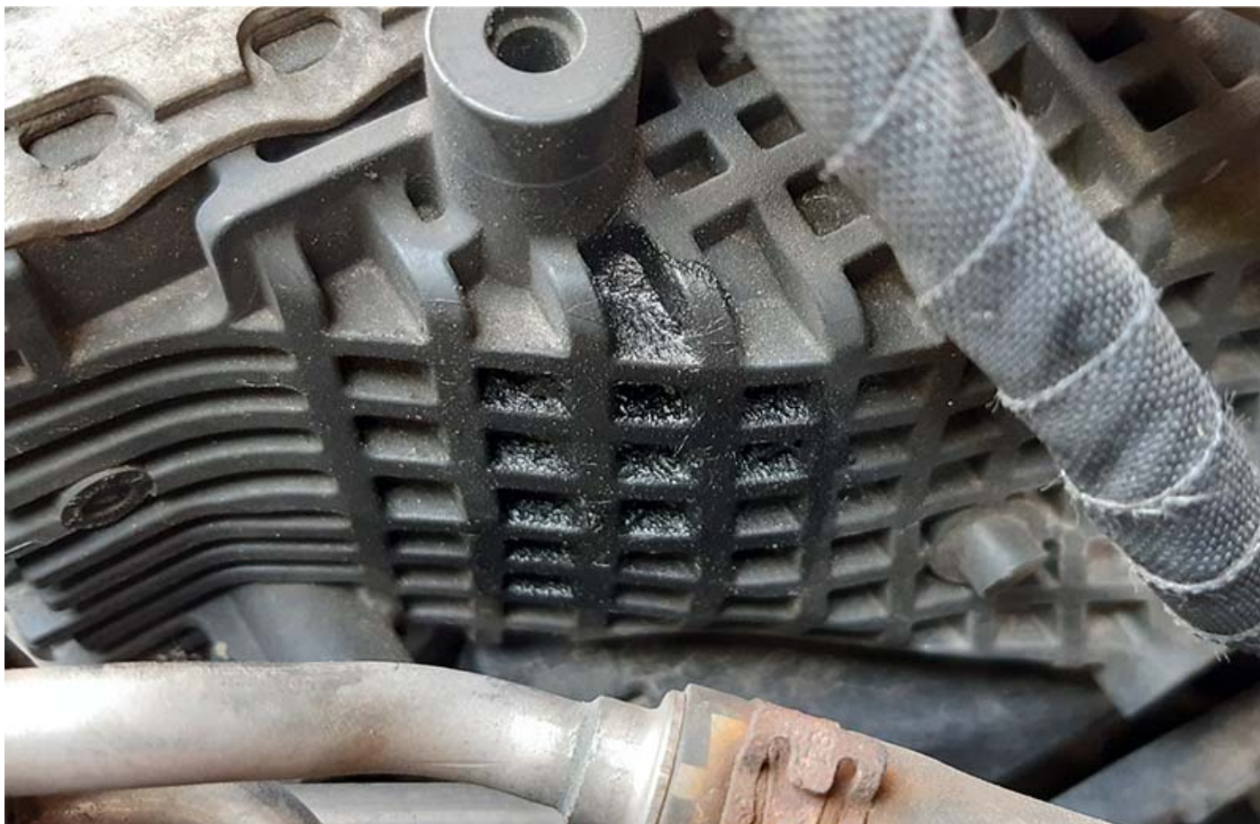
Image 2 : traces d'huile sur refroidisseur d'air de suralimentation
