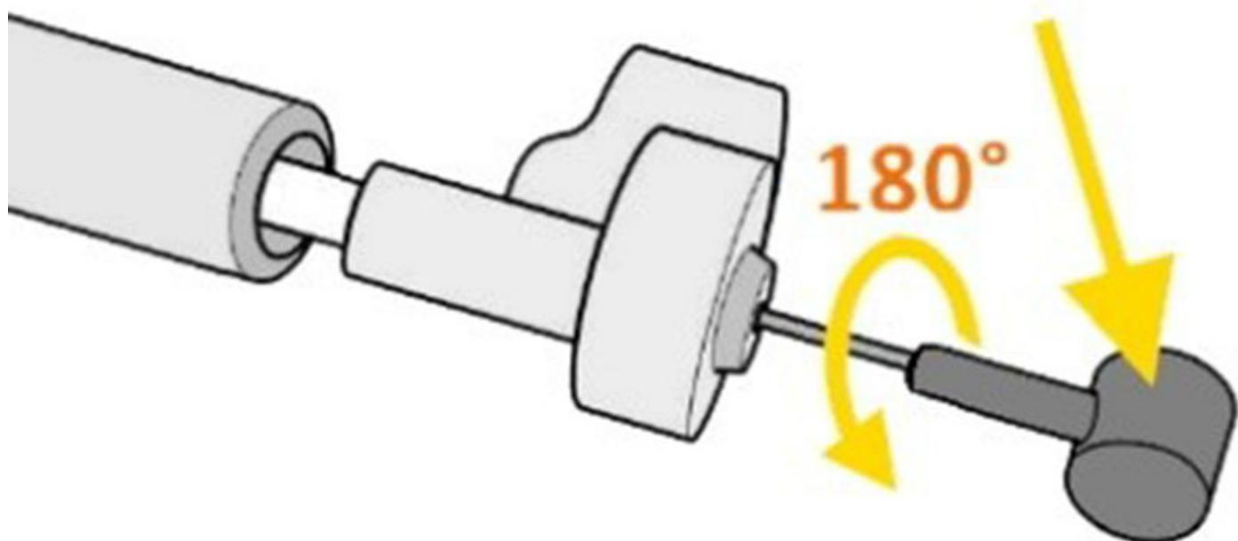
Turner le câble intérieur au niveau du mamelon de 180° dans le sens inverse des aiguilles d'une montre
