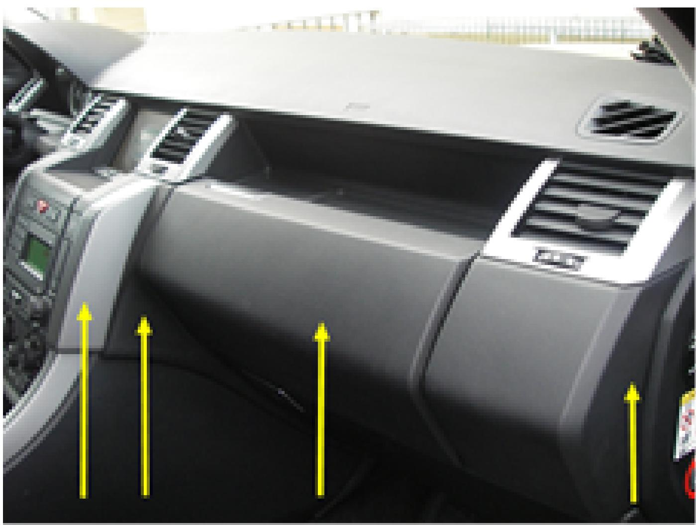
Si des bruits - grincements, crissements, les causes exactes étant difficiles à déterminer - apparaissent sur les Range Rover Sport (voir modèles ci-dessus) dans la zone de la planche de bord, il s'agit vraisemblablement de la formation de salissure dans les commandes des trappes de l'air recyclé. Ce bruit est amplifié d'une manière flagrante lorsque le système de climatisation passe en mode air recyclé.
