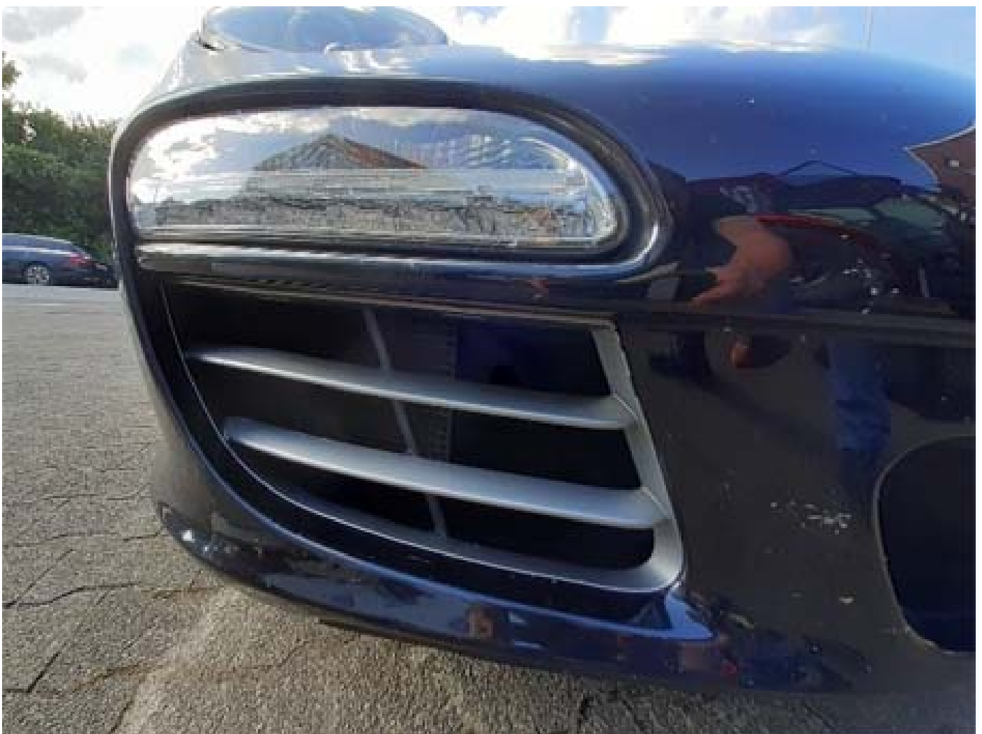
Photo 1 : Les radiateurs sont situés à gauche et à droite derrière les grilles d'aération du pare-chocs.
