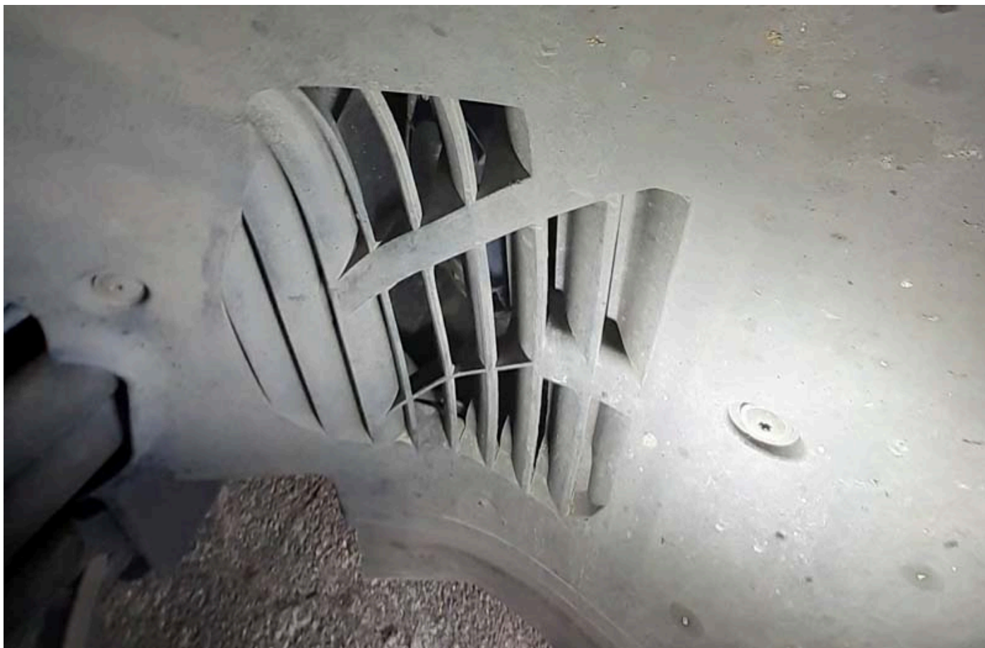
Photo 2 : Les ventilateurs eux-mêmes sont accessibles depuis le passage de roue si la garniture du passage de roue est déposée.
