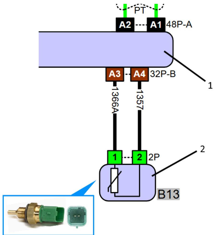
Schéma Peugeot Légende : 1 : calculateur moteur 2 : capteur de température de liquide de refroidissement
