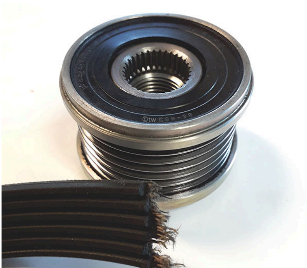
Poulie à roue libre défectueuse avec courroie trapézoïdale à nervures fissurée
