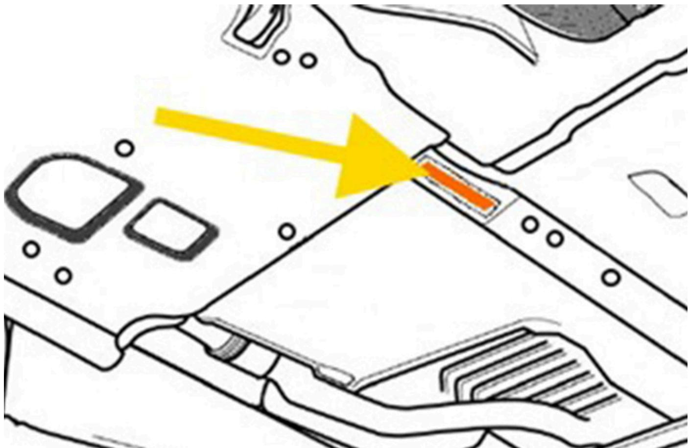
Nettoyer soigneusement la zone marquée sur la figure et poser l'appui en mousse réf. OE 16111181918 selon les indications du constructeur automobile.
