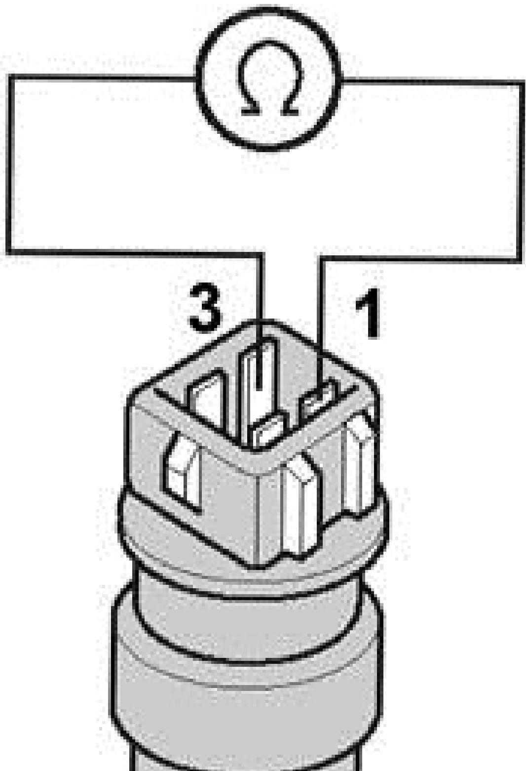
Si le client signale le défaut mentionné ci-dessus, la sonde de température et/ou son câble de raccordement vers le calculateur moteur peuvent être en cause. La réclamation peut en outre également porter sur un moteur ne tournant pas rond. A la lecture de la mémoire des défauts, les codes d'erreur 16500, 16501 et 16502 peuvent être enregistrés. Ceux-ci se fondent sur le défaut de fonctionnement de la sonde de température de liquide de refroidissement. Dans ce cas, procéder comme suit :
