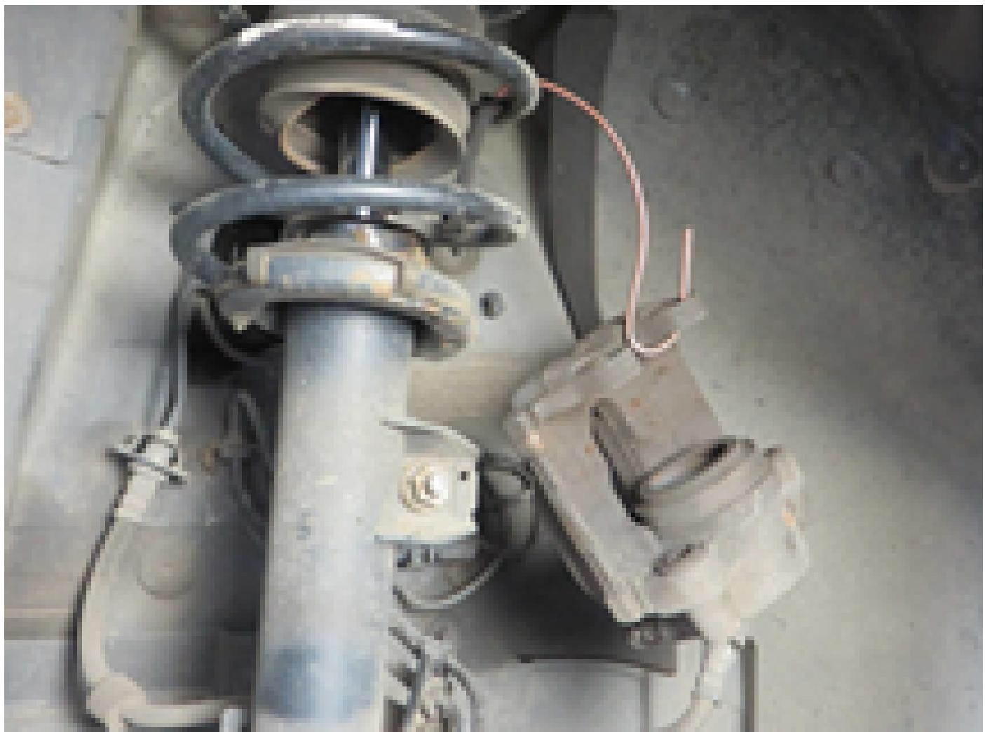
Aflojar ambos tornillos de fijación del soporte de la pinza de freno y desatornillarlos.
