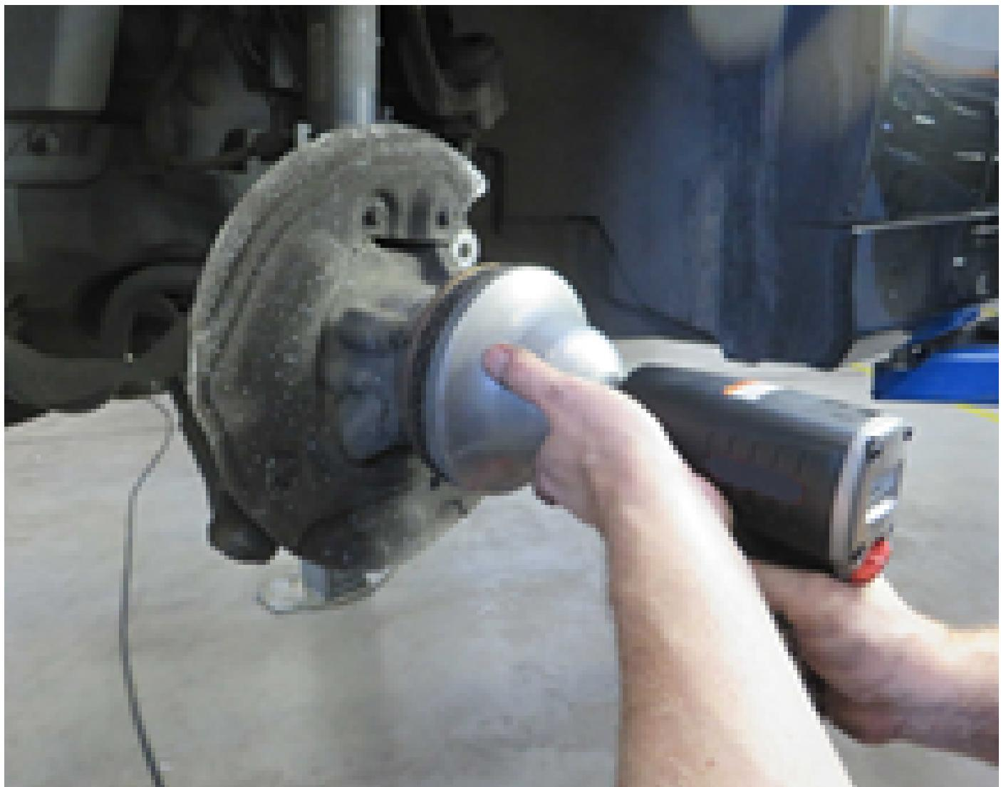
La superficie de contacto del cubo de la rueda no debe estar dañada ni presentar restos de óxido, por lo que debe mantenerse limpia y sin restos metálicos. Como protección ante la corrosión, puede pulverizarse suavemente un lubricante que deberá retirarse después con un paño que no deje pelusas.
