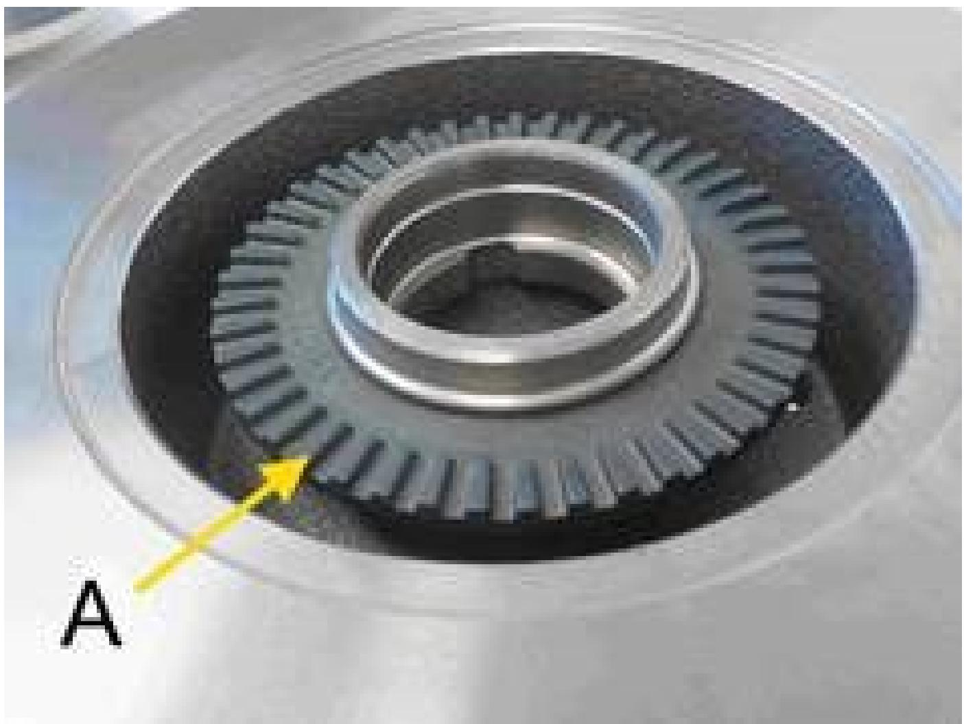
Disco de freno sin rodamiento de la rueda, con anillo impulsor montado firmemente y engranaje dispuesto en vertical (A).
