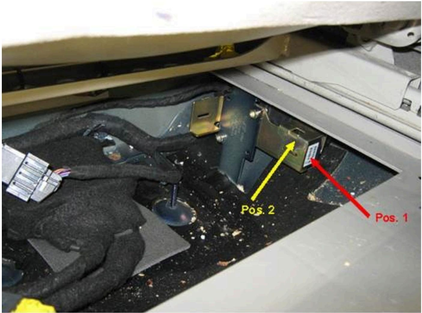
Para estar seguros de que el sensor ha causado la avería, primero hay que leer la memoria de averías y después hay que comprobar el cableado del sensor.
