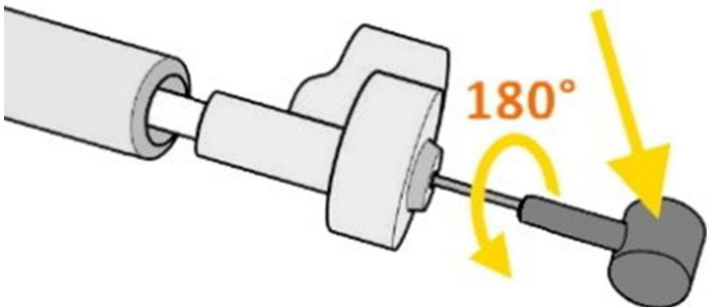
Gire el cable interior en la cabeza cilíndrica  $180^\circ$  en sentido contrario a las agujas del reloj
