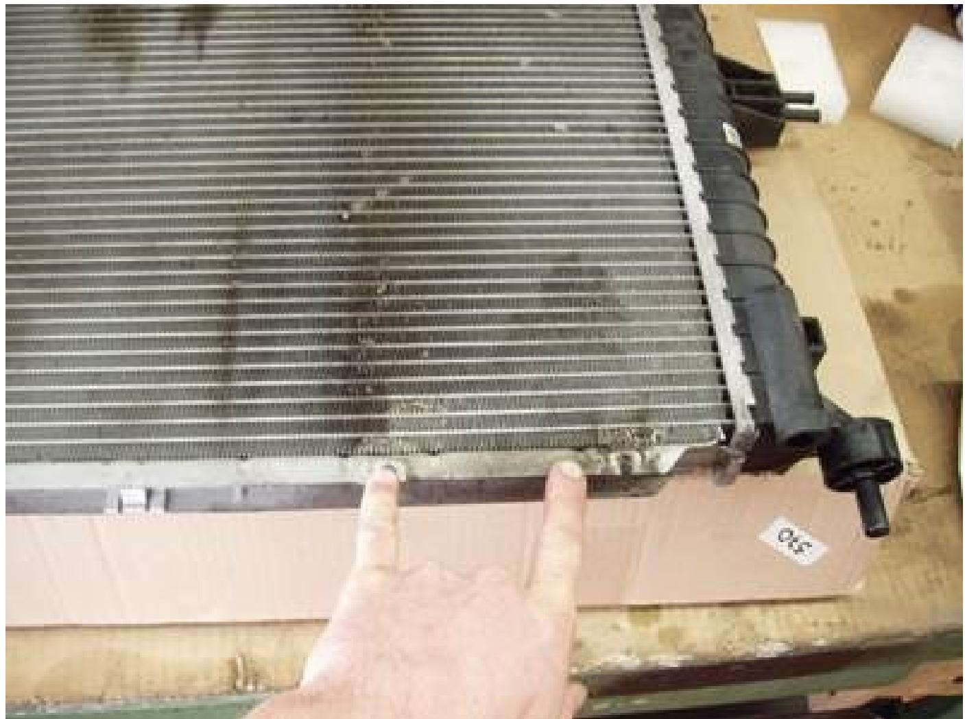
En el montaje del nuevo radiador, el soporte debe fijarse de tal manera que debe quedar descartado el hecho de volver a provocar daños en el radiador.
