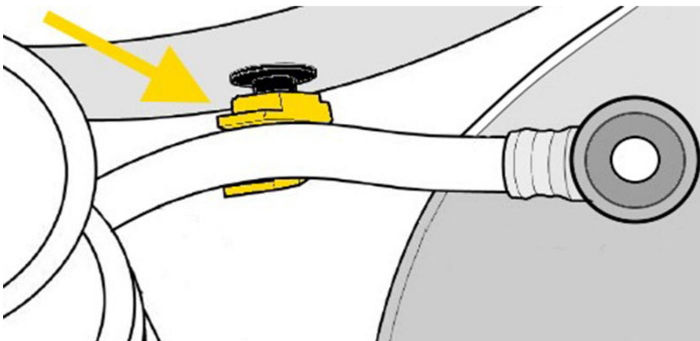
Fijación insuficiente del conducto de vacío del servofreno debido a una grapa de sujeción defectuosa.
