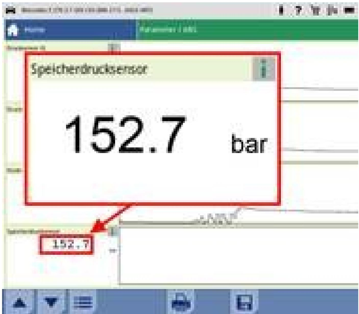
**Conectar el equipo de diagnosis** **Arrancar el motor** **Accionar el pedal del freno varias veces para aumentar la presión en el acumulador de presión** **Leer los valores actuales/parámetros (imagen)**
