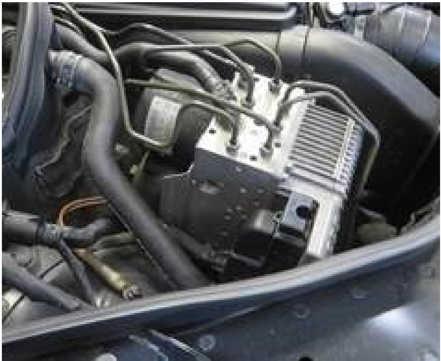
**Si se alcanza un nº determinado de frenadas, quiere decir que se ha alcanzado el llamado límite de servicio y que la unidad hidráulica deberá sustituirse.**
