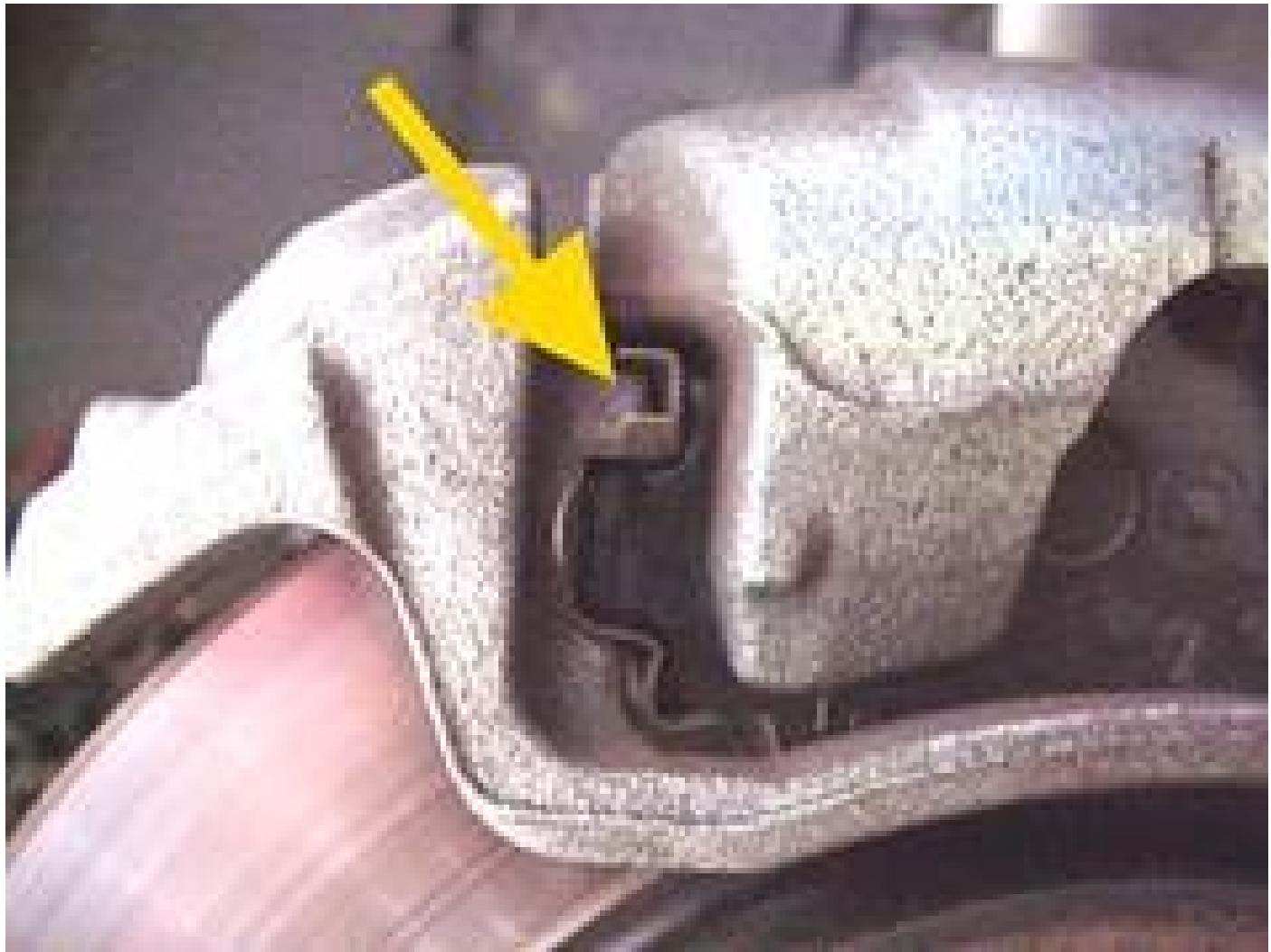
**Cuando se lleve a cabo el mantenimiento del freno de la rueda deberá eliminarse toda la suciedad y la corrosión de las superficies del soporte de la pinza y deberá tratarse con un producto anticorrosión. También deberán lubricarse las placas guía de acero inoxidable.**
