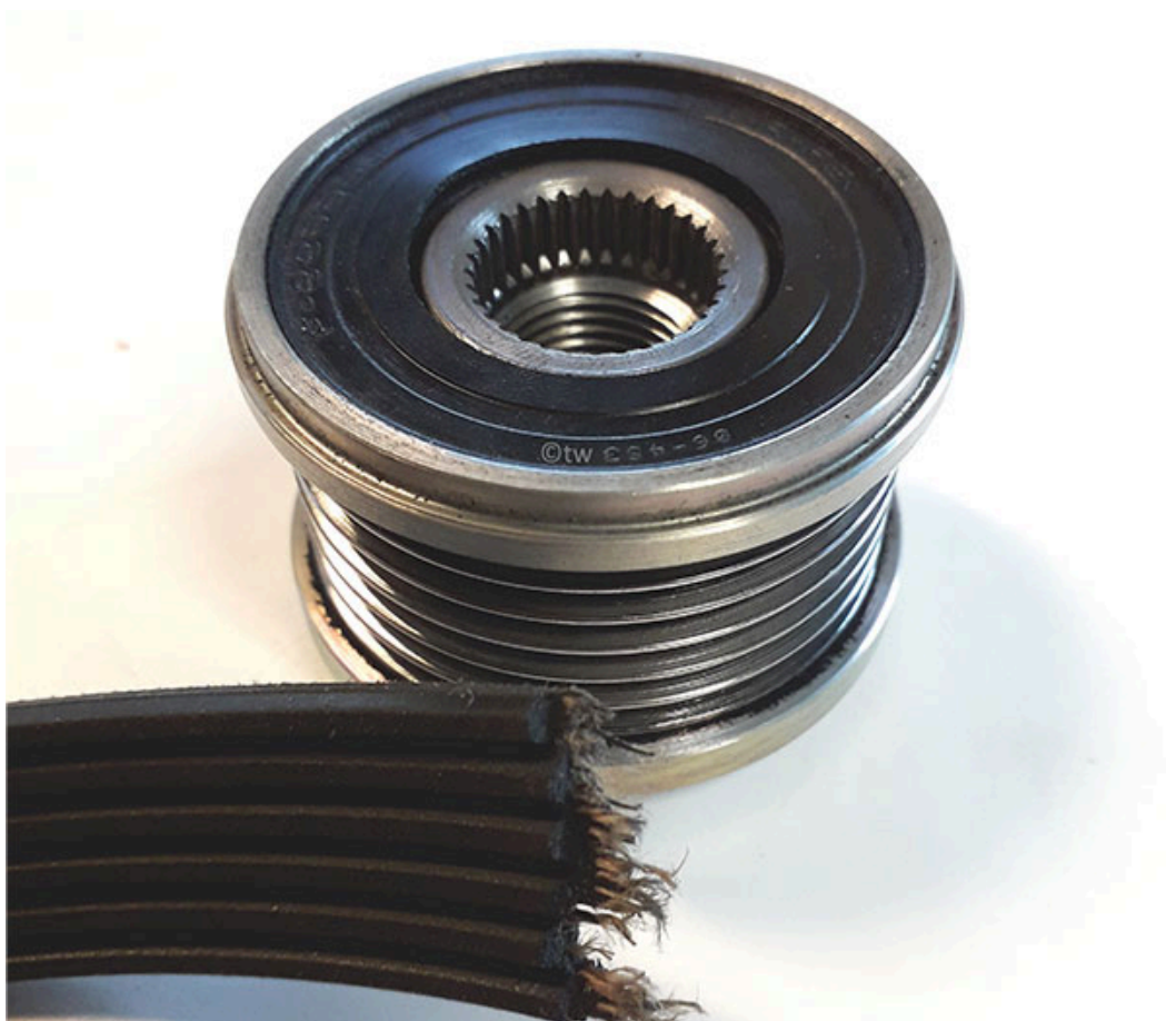
Polea de rueda libre defectuosa con correa trapezoidal estriada rota
