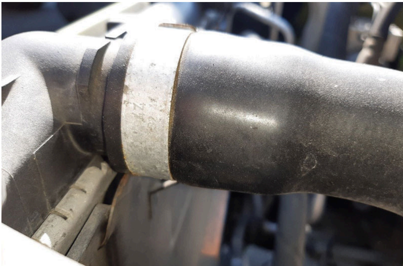
Manguera de agua de refrigeración en el radiador
