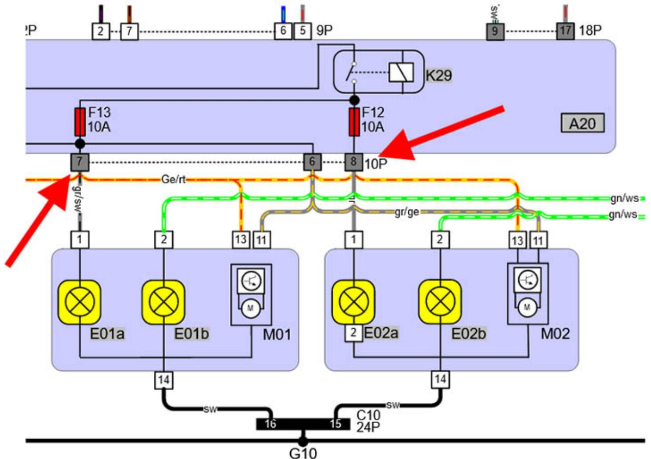
Conexión enchufable en la unidad de control de la red de a bordo (A20). Luz de cruce izquierda (E01a) Luz de cruce derecha (E02a)
