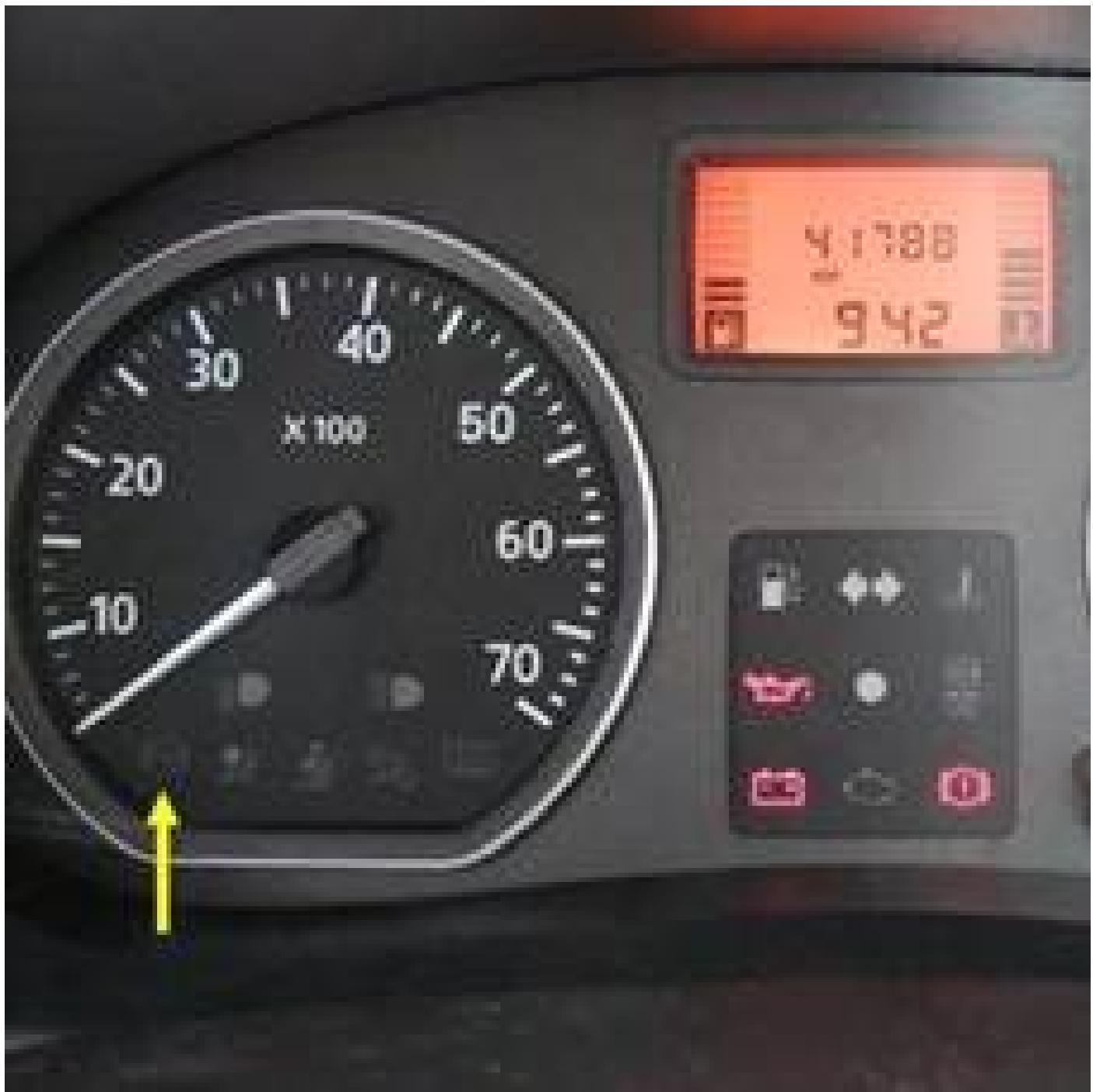
Un problema en el tablero de instrumentos puede provocar que no se indique el fallo en el sistema del ABS. Incluso en el proceso de autocomprobación tras conectar el encendido es posible que no se encienda la lámpara de control del ABS (ver imagen).
