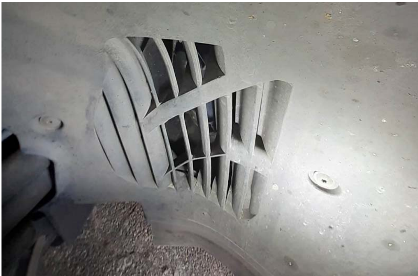
Billede 2: Du får adgang til ventilatorerne fra hjulhuset, hvis hjulhusbeklædningen først er afmonteret.
