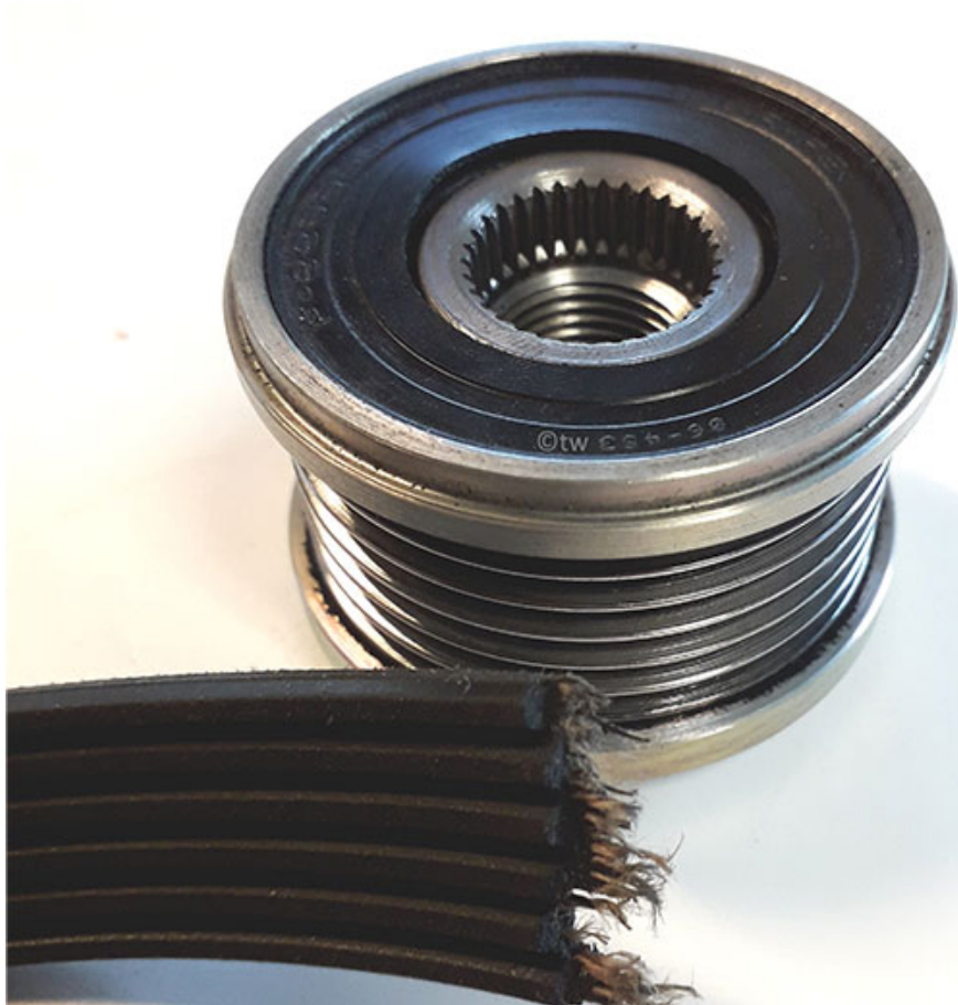
Defekt friløbsskive med ødelagt kilerem
