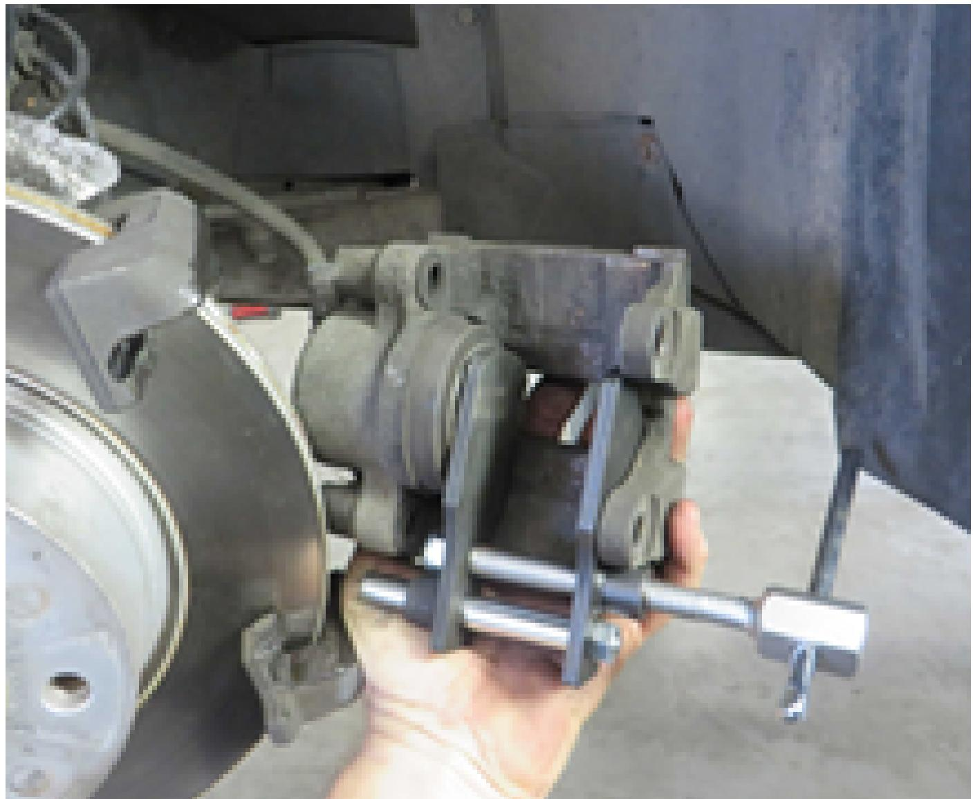
Den Bremssattel mit Bremsenreiniger reinigen.
