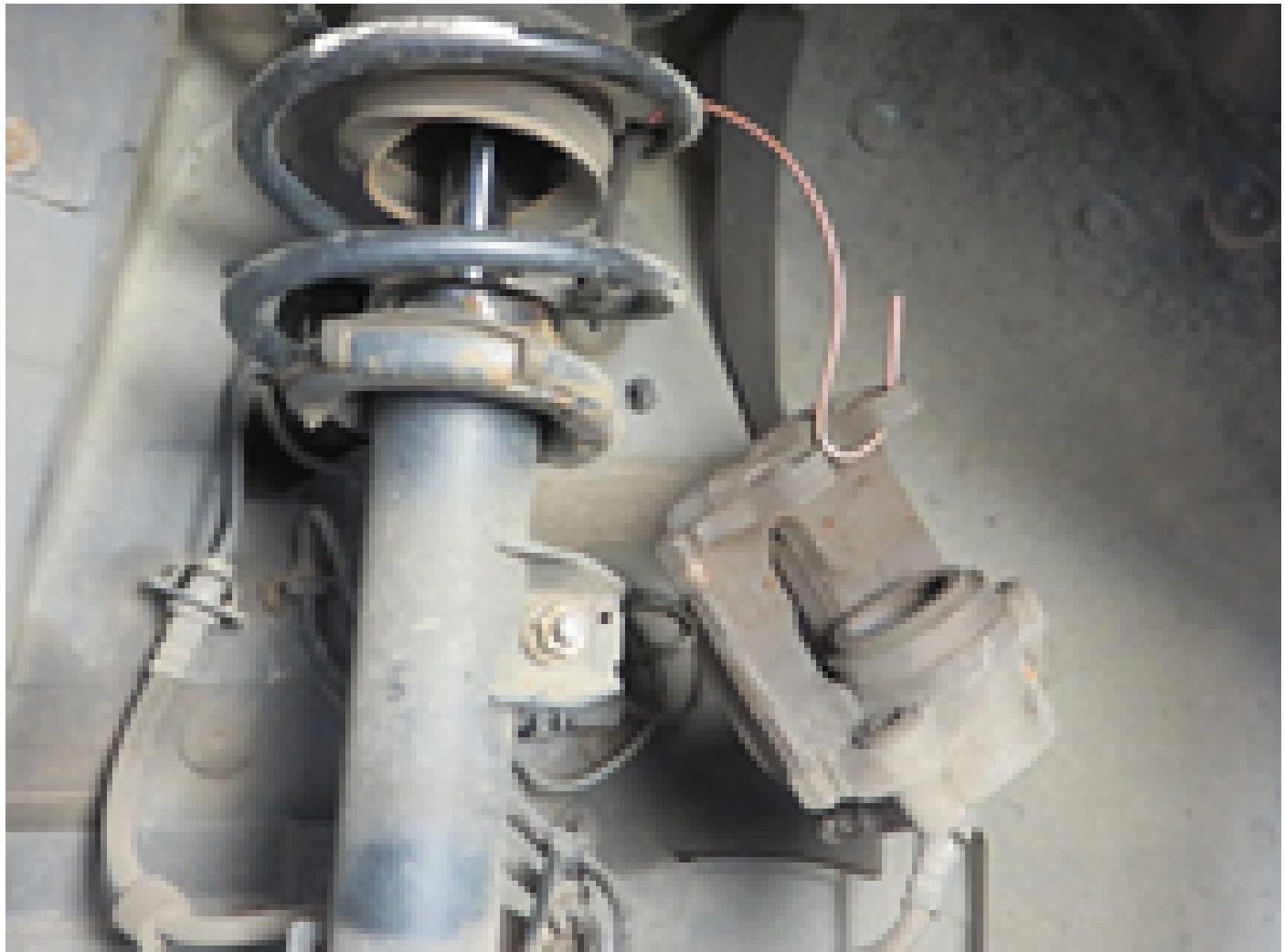
Beide Befestigungsschrauben des Bremssattelträgers lösen und herausdrehen.
