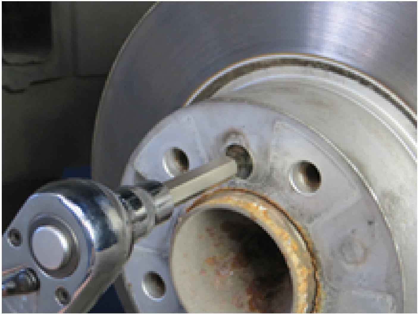
Bremssattelträger zur Montage vorbereiten.
