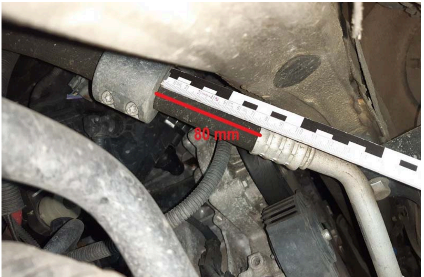
<p>Bild 1: Schwingungsdämpfer zur nachträglichen Montage</p>
