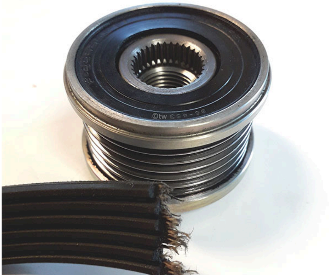
<p>Defekte Freilaufriemenscheibe mit gerissenem Keilrippenriemen</p>
