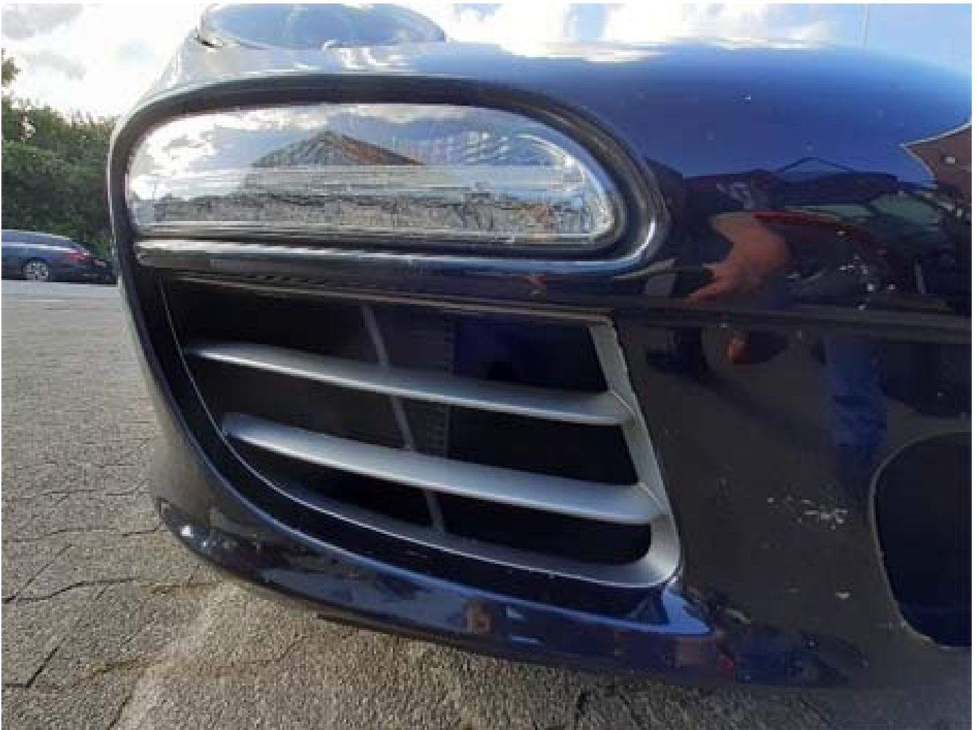
Fig. 1: Los radiadores están situados a la izquierda y a la derecha, detrás de la rejilla de aire en el parachoques.
