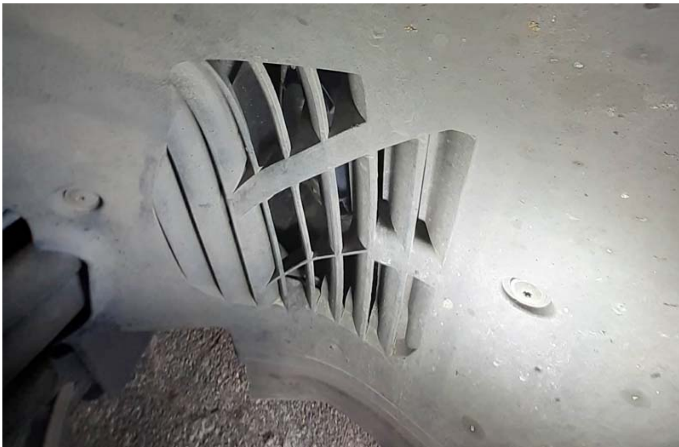
Figura 2: Os ventiladores são acessíveis a partir da cava da roda, se previamente o revestimento da cava da roda tiver sido desmontado.
