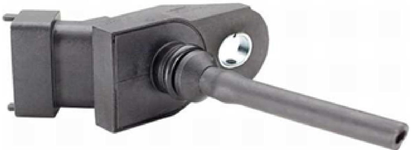
Aviso técnico para o sensor da pressão atmosférica/ sensor de altitude: Para evitar uma saturação da misturam é reduzido o tempo de injeção em caso de aumento da tensão do sensor.
