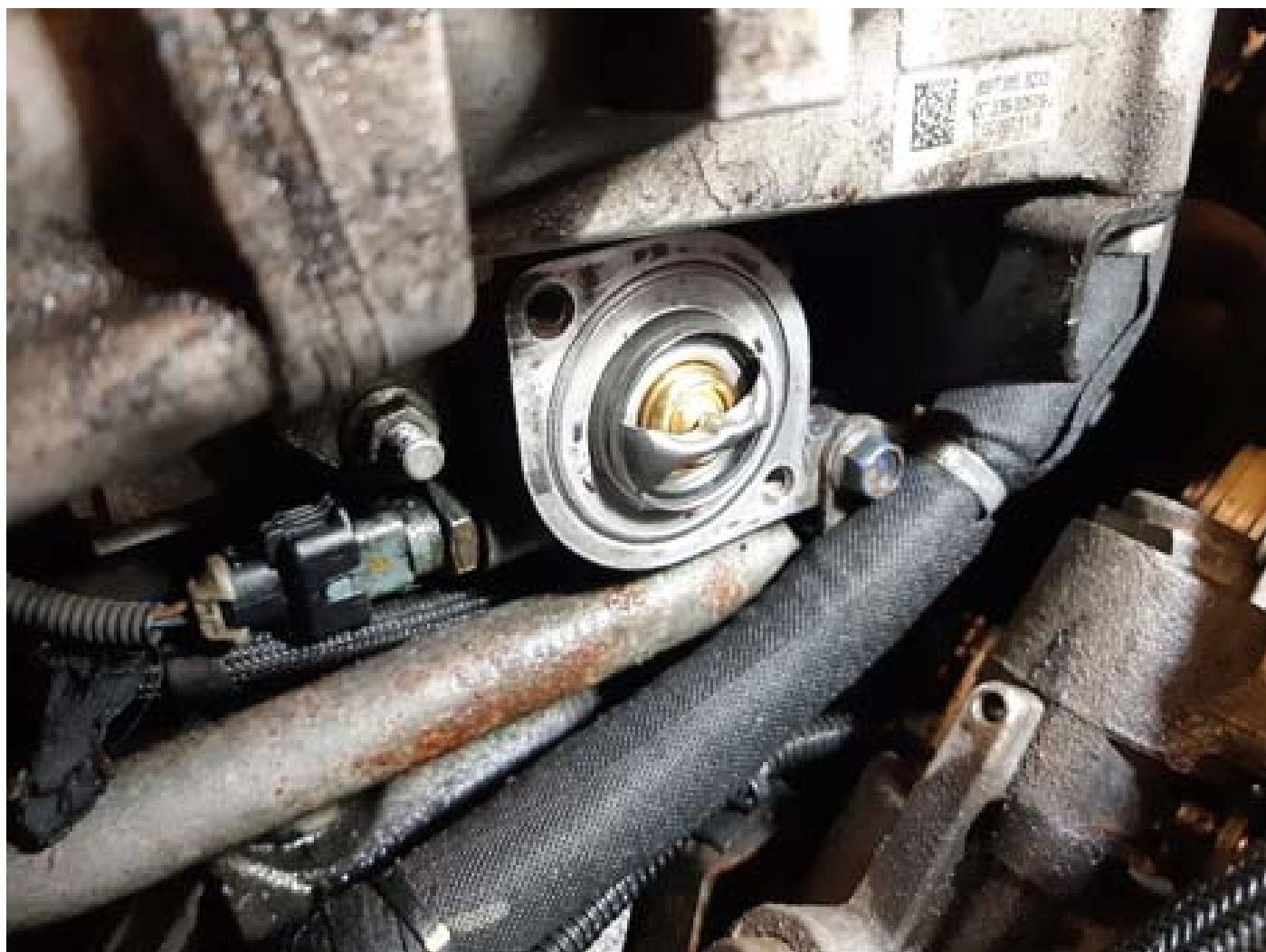
Figura 2: o termóstato está visível e pode ser substituído
