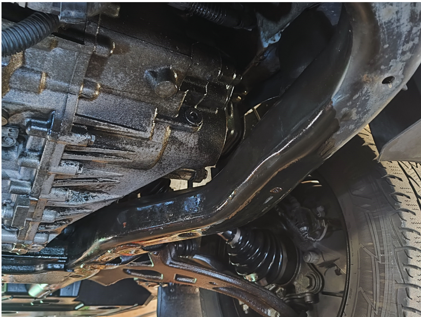
Fuga de combustível T6
