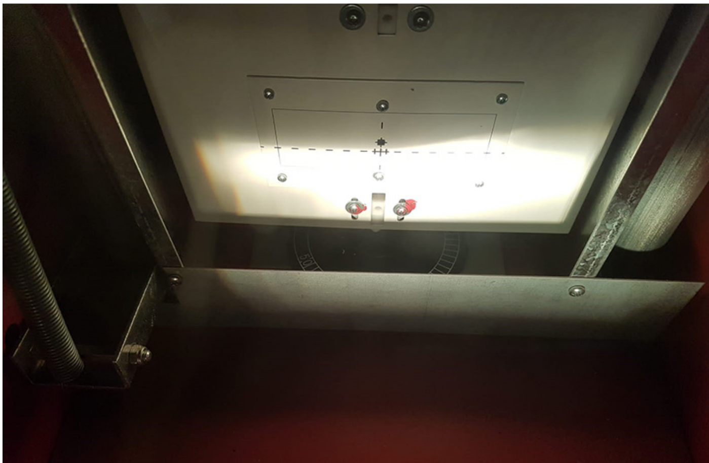
Figura 2: o limite claro/escuro e o ângulo assimétrico são claramente visíveis
