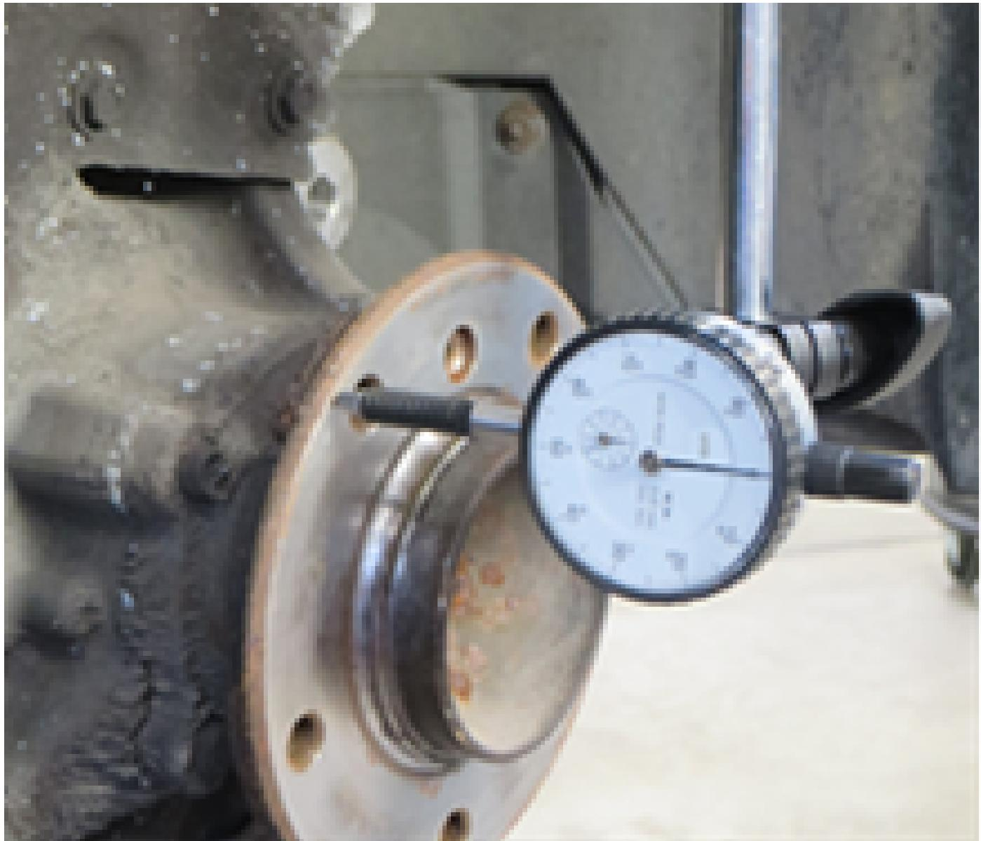
**Il est nécessaire d'effectuer ce contrôle avant le montage de nouveaux disques de frein. Des défauts de planéité au niveau de la surface de contact du moyeu de roue peuvent déformer le disque de frein et le voiler! Un voilage simple du moyeu entraîne un double voilage au bord extérieur du disque de frein.**
