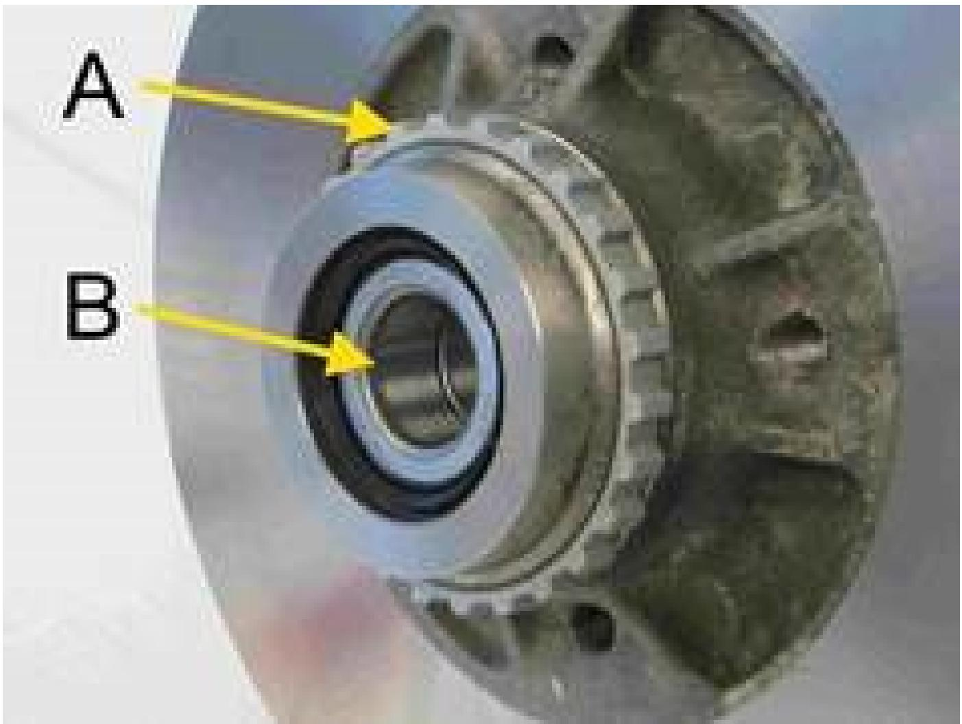
Les roulements de roue intègrent dans leur joint d'étanchéité en même temps une bague multipôle (roue codeuse) qui peut être également utilisée comme une roue d'impulsion. Des aimants avec inversion de polarité sont intégrés dans le joint d'étanchéité.
