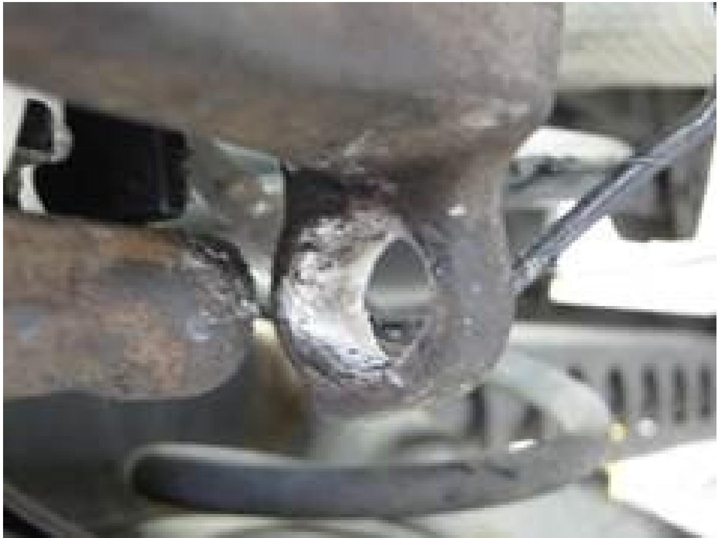
**Utiliser pour ce faire un alésoir approprié pour réparer le perçage de façon homogène. Dans le cadre de cette réparation, remplacer les manchons d'amortissement et, si nécessaire, les boulons de guidage.**
