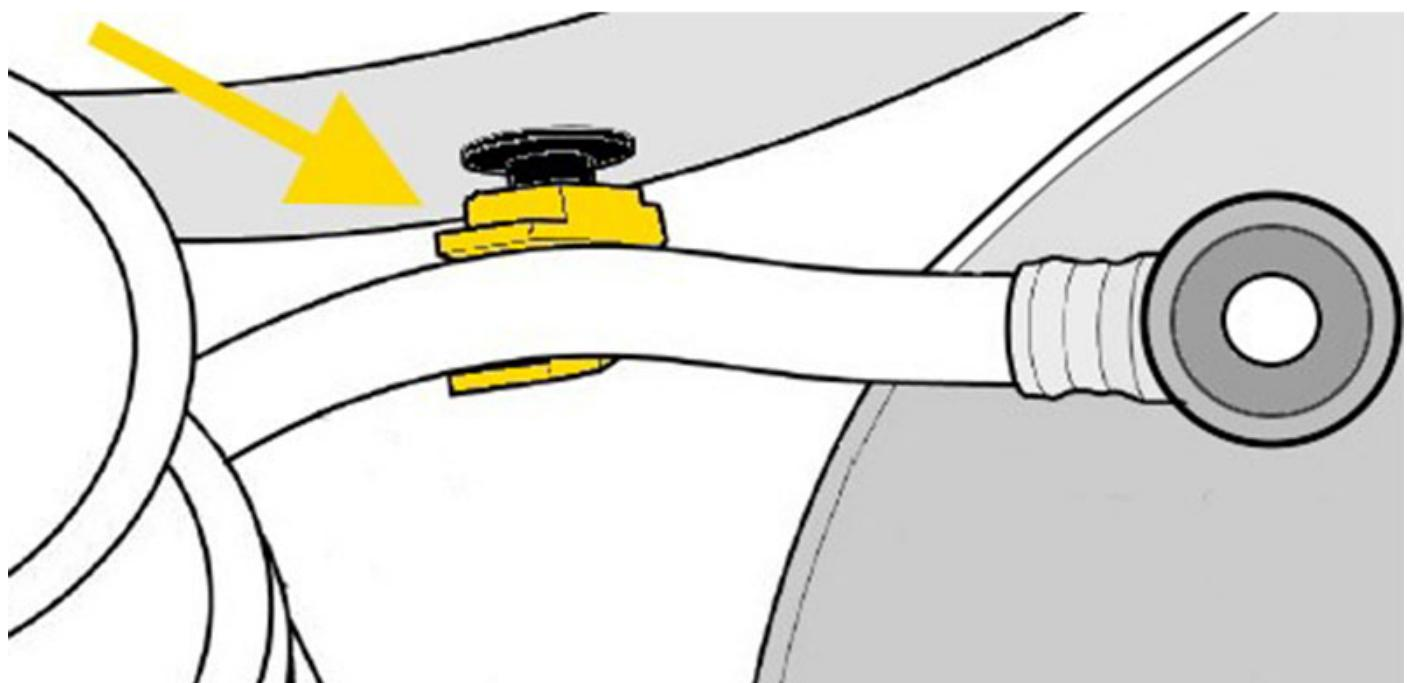
Fixation insuffisante de la conduite de dépression du servofrein du fait d'une pince de maintien défectueuse.
