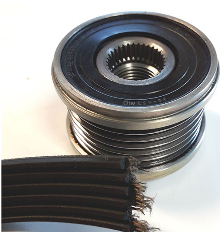
Poulie à roue libre défectueuse avec courroie trapézoïdale à nervures fissurée
