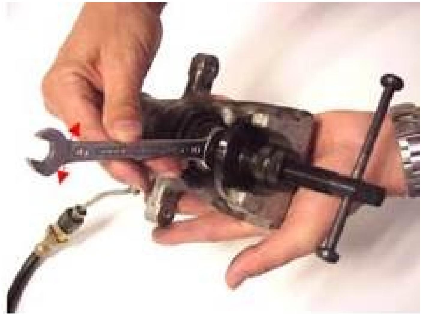
Les pistons des étriers de frein connus jusqu'ici se rétractent par rotation dans le sens des aiguilles d'une montre.
