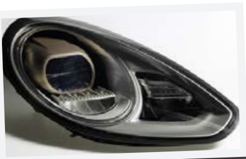
Una apuesta futura: Prototipo de un faro HD de cristal líquido
