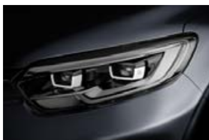
Clase compacta / Renault Kadjar (2015): Faro principal LED con módulos mono- LED de HELLA para la luz de cruce y la de carretera
