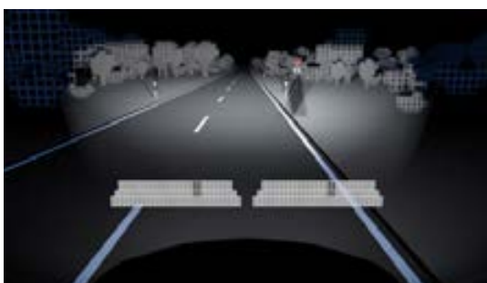
Detección de las señales de tráfico con reducción de autodeslumbramiento
