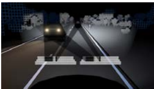
Luz de carretera que no deslumbra gracias a que se apagan determinados módulos lumínicos
