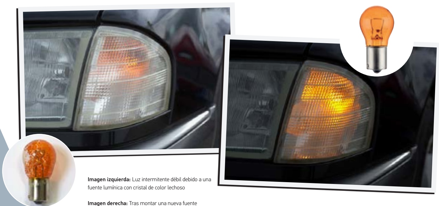
Imagen derecha: Tras montar una nueva fuente lumínica PY21W, la función de la luz intermitente se ha restablecido completamente.
