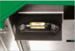
Con el nivel de burbuja, el SEG IV puede alinearse exactamente en paralelo a la base.
