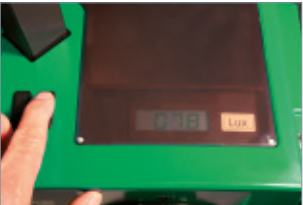
El luxómetro digital permite determinar de forma rápida y precisa el valor de deslumbramiento de la luz de cruce, así como la intensidad de iluminación de la luz de carretera.
