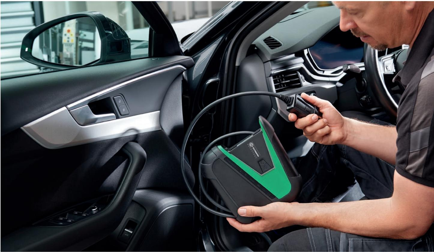
En la robusta carcasa del mega macs X se concentra toda el sistema lógico del equipo: el procesador, el software y los protocolos de diagnóstico integrados, entre otros CAN FD y DoIP para las últimas generaciones de vehículos. Se trata de una gran ventaja, ya que muchos equipos de diagnóstico antiguos no soportan estos protocolos de comunicación.
