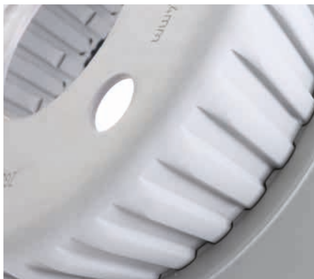
Tarcza hamulcowa firmy Mercedes Benz z zębatą piastą z blachy stalowej
