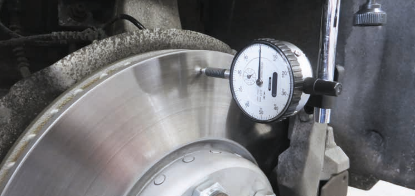
Kontrola tarczy hamulcowej przy użyciu czujnika zegarowego
