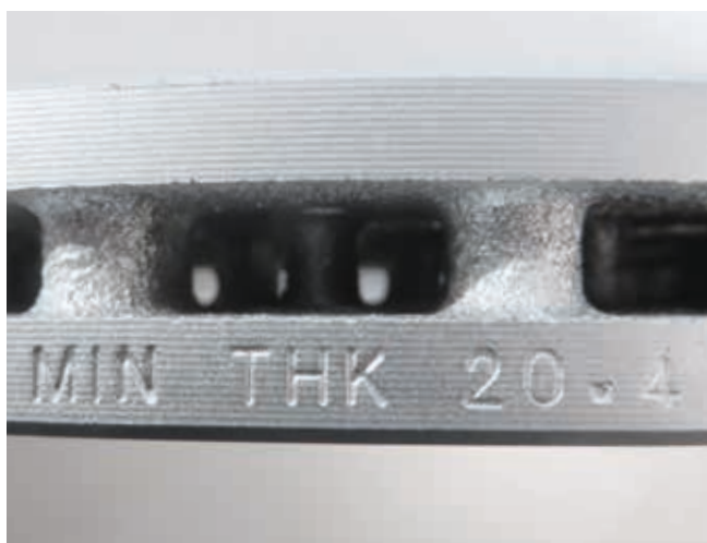
Minimalna grubość wybita na krawędzi tarczy hamulcowej
