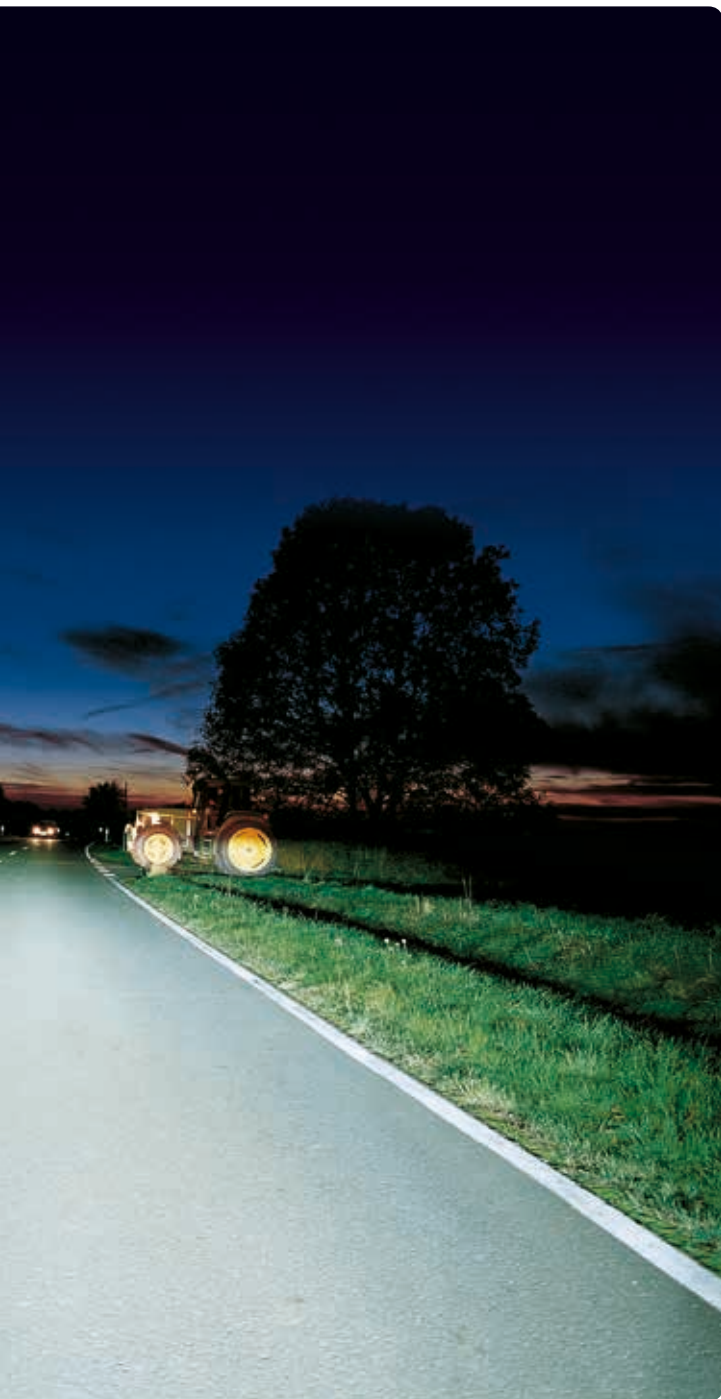
Typische Lichtverteilung und Farbtemperatur eines Scheinwerfers mit Gasentladungslampen.
