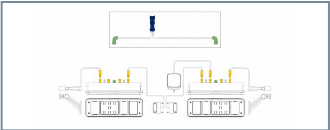
SUPERSEAL-Verkabelungssystem am Beispiel der Multifunktionleuchte
