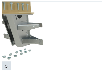
5 Konsolen am Fahrzeug befestigen.
